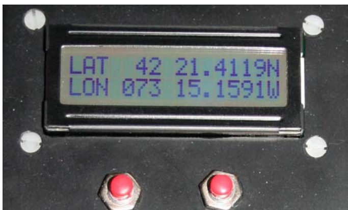
Figure 1 - 3DfixLCD displaying latitude and longitude
