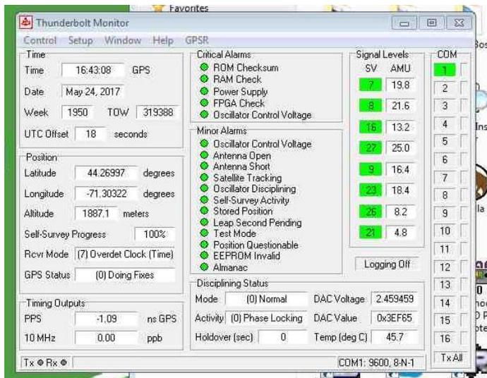
Fig. 5 – GSP Tracking Eight Satellites
